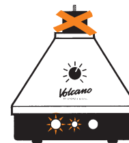
Risque de brûlure ! Ne pas laisser la chambre de remplissage en place sur le VOLCANO
