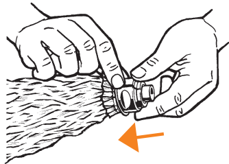
Fixer le ballon avec la deuxième bague de fixation
